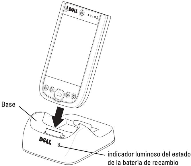
Cuando el dispositivo esté acoplado en la base, el botón de alimentación del dispositivo se enciende y aparece el icono de estado de la conexión en la barra de comandos (consulte la página 67).
